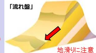
流れ盤とは、地層の傾斜が地形の傾斜に対して平行に傾斜しているもので、土木工事では切土部において、地滑りなど崩壊に備えた注意が必要です。
