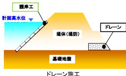
ドレーン工は、平時や洪水時に堤防に浸透した降雨ならびに河川水を裏のり尻のドレーン部に集水し、堤防外に速やかに自然排水する機能を長期にわたって有する対策工であり、主として堤体の浸潤面の低下を目的とするものです。
