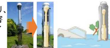
浸水時の機能確保のための防水対策
