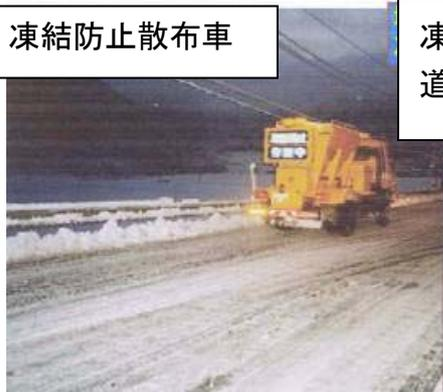
凍結防止剤(塩化ナトリウム=塩)を道路に散布する機械
