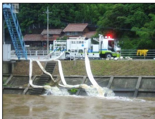
排水ポンプ車による支援活動
