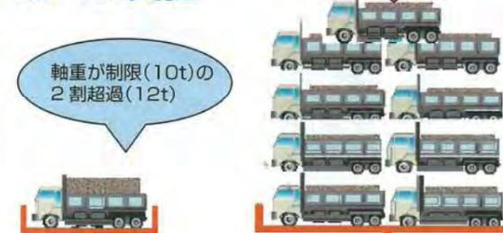
仮に、大型車両1台が、軸重10トンの基準よりも2トン超過した場合は、舗装に対しては約2台分、RC床版に対しては約9台分の疲労が蓄積されることとなります。
