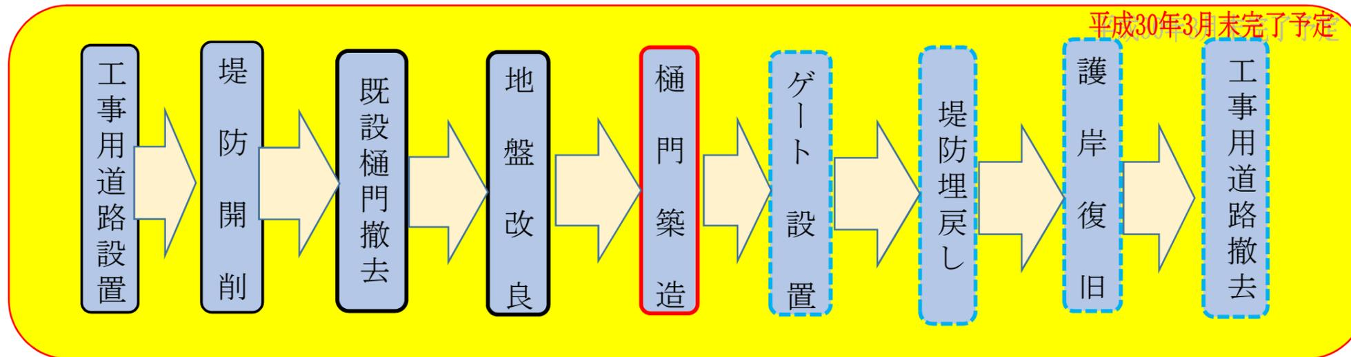
11月末迄に既設樋門の取り壊しを完了し、12月は新たな樋門の基盤となる地盤改良と止水矢板を設置。
