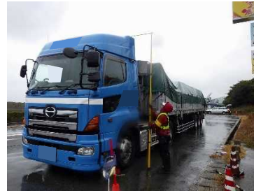
(車両高さ計測)
