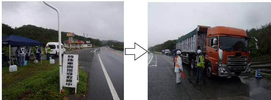
車両重量計測・寸法計測(幅)
