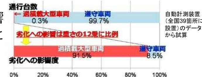
基準の2倍以上の重量超過の悪質違反者に厳罰化⇒現地取締りで違反を確認した場合は告発(レッドカード)
