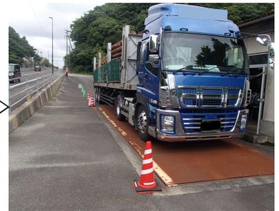
車両重量計測・寸法計測(幅)
