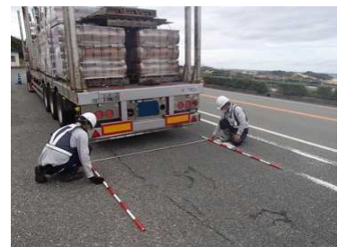
車両重量計測・寸法計測(幅)
