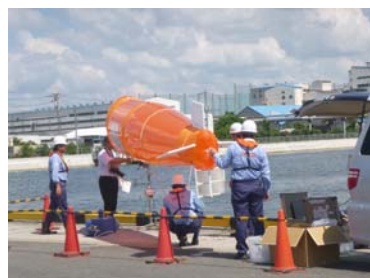
気球空撮システムによる港湾の被災状況調査
