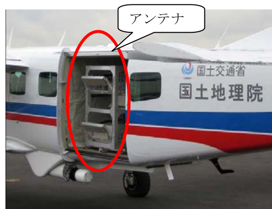
写真1 航空機 SAR を搭載した「くにかぜⅢ」
