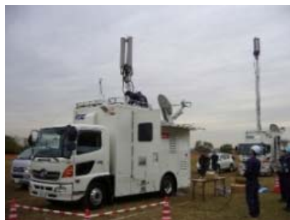
アンテナ立ち上げ
