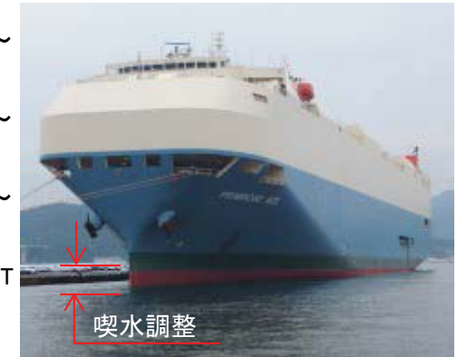
自動車運搬船の喫水調整状況
