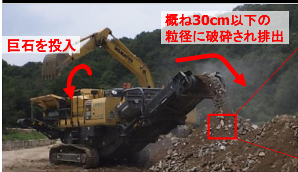
【専用重機による破碎状況】
