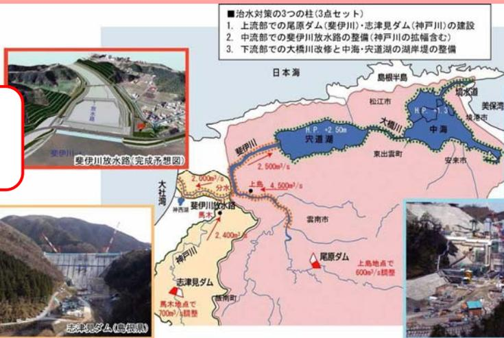
堤防の建設と川の拡幅により、洪水を安全に流下
