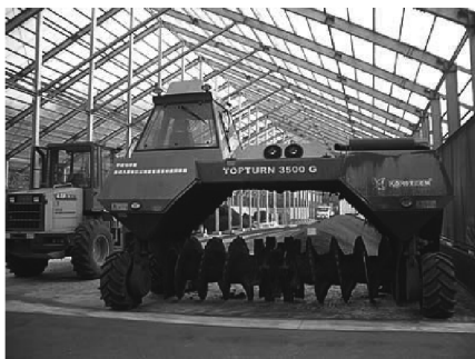
トップターン(自走式攪拌機)による堆肥化作業の様子
