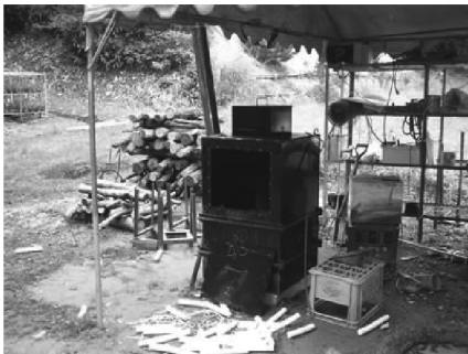
加温機(ストーブ)試作 1 号機。燃料補給なしで連続 15 時間の連続運転が可能
