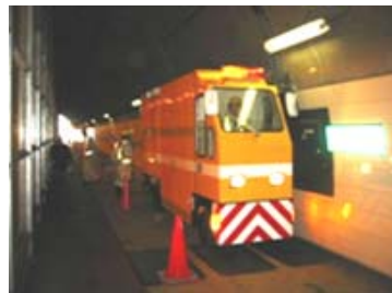
小幅トンネル清掃車の開発
