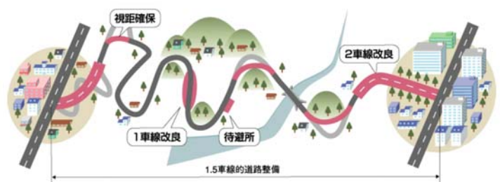
▲地域の実情に対応した1.5車線整備
