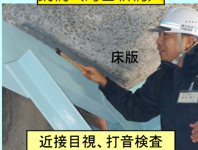
鋼板腐食状況及び水みち確認
