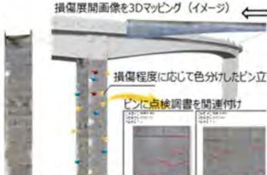
・供用中の橋梁や水門を対象に、3次元モデルを生成し損傷管理を行う技術を開発
