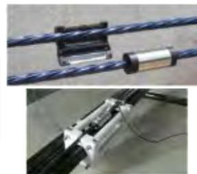
センサーによる橋梁ケーブル張力のモニタリング
