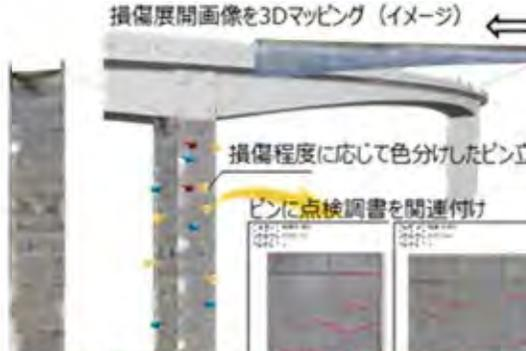
・供用中の橋梁や水門を対象に、3次元モデルを生成し損傷管理を行う技術を開発
