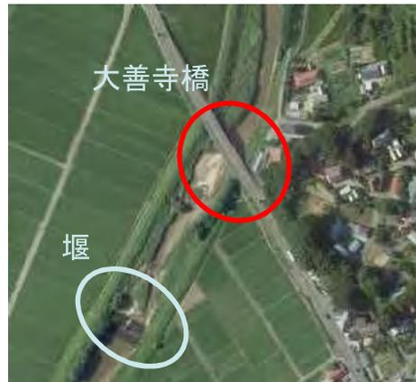
上流に可動堰が存在⇒土砂供給が少なくなる
