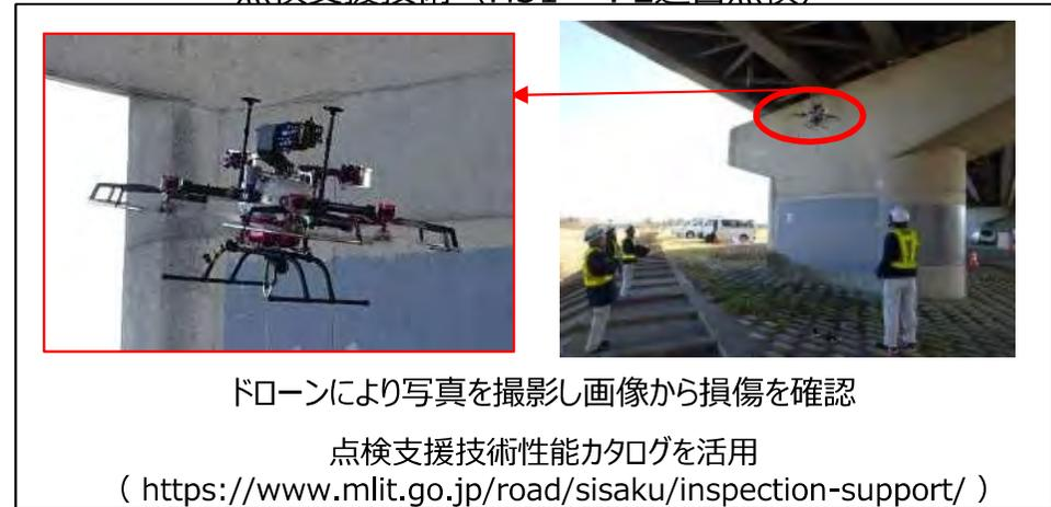
ドローンにより写真を撮影し画像から損傷を確認
