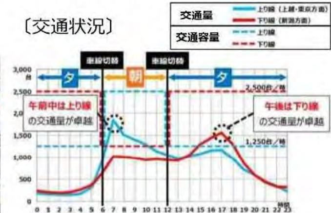
〔渋滞対策: ロードジッパーシステムを用いた時間帯別車線運用〕
