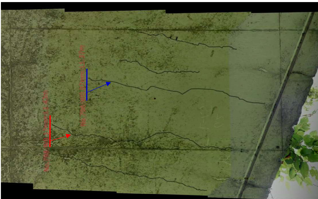
検証位置① (ひびわれ幅 0.2mm 0.15mm ) 「ひびみつけ」 ひびわれ幅 上位 40%値 0.17mm 0.07mm
