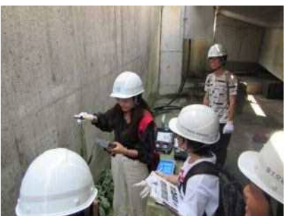
▲ コンクリートの強度測定 (非破壊)を体験
