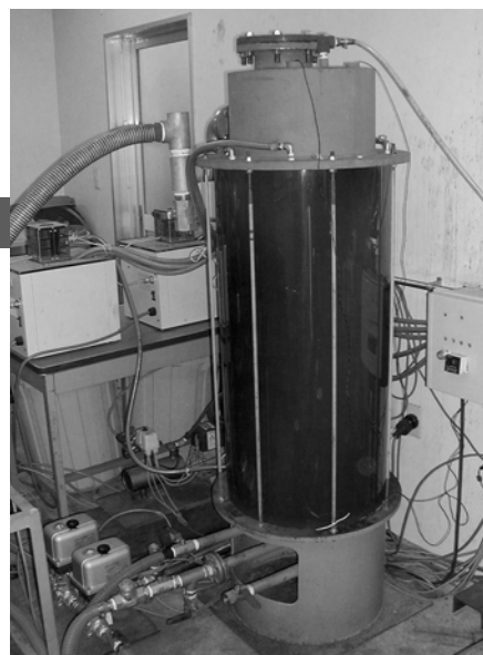
発酵実験設備
