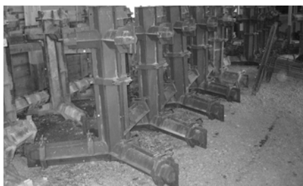
ランチブロックの型。この中に鉄筋を組み込み、コンクリートを流し込んで固める
