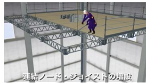
連結ノード・ジョイントの増設
