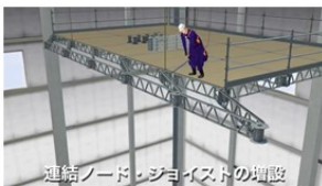
連結ノード・ジョイントの増設
