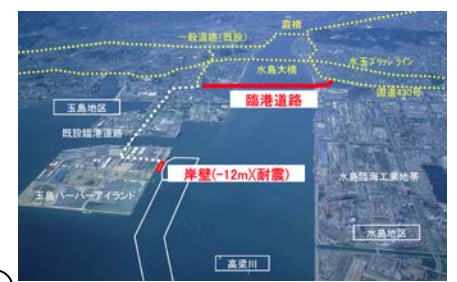
耐震強化岸壁の整備 水島港玉島地区
