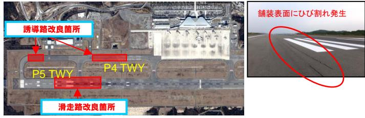
舗装表面に経年劣化によるひび割れが発生
