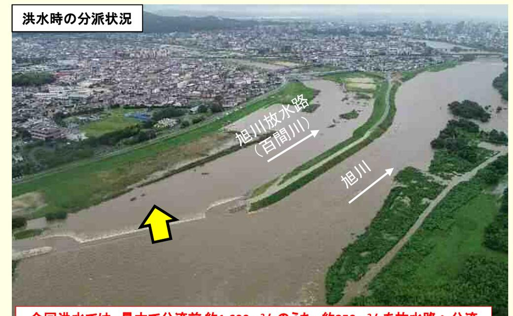
今回洪水では、最大で分流前約1,600m<sup>3</sup>/sのうち、約250m<sup>3</sup>/sを放水路へ分流
