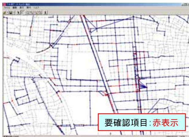
図 - 3 下水管路データチェック結果表示
