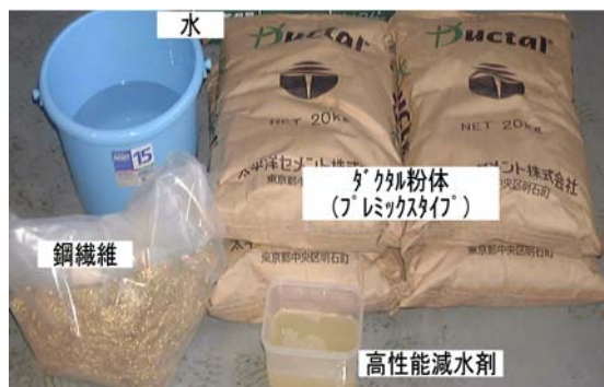
写真-3 ダクトルの材料構成
