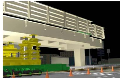
図-4 1径間分の施工手順
