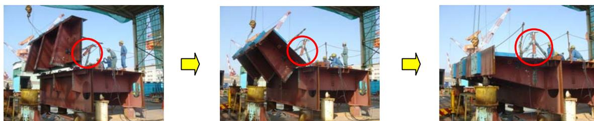
図-6 小型ジャッキによる展開試験
