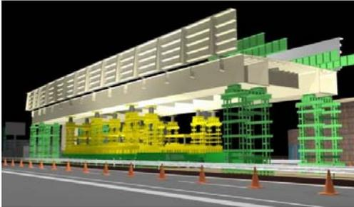
(3) リフトアップ装置にて高さ調整を行い、橋脚柱を接合する。
