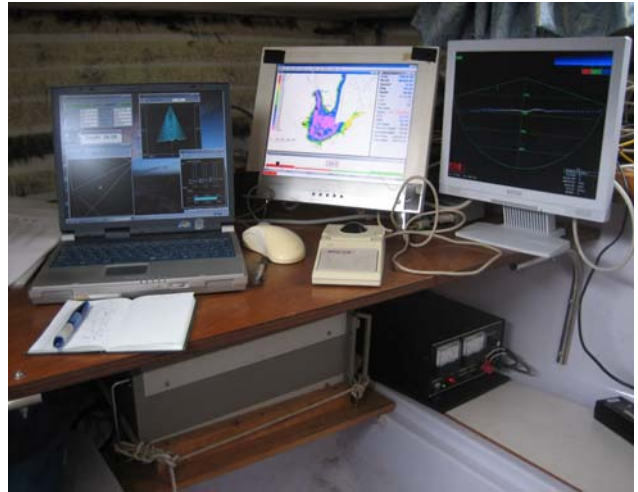
写-6 ナローマルチビーム測深システム
