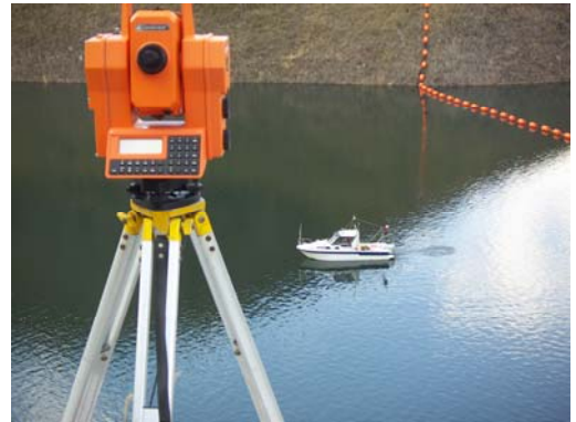
写-1 ATS システム
