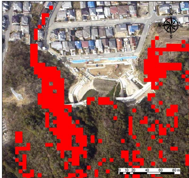
図一六 植物活性度 (NDVI) と斜面傾斜度から推定された相田地区の調査候補地マップの例 (「 0.4 < \text{NDVI} < 0.7 」かつ「斜面傾斜度 > 30^\circ 」の条件にあてはまる場所が赤の範囲)
