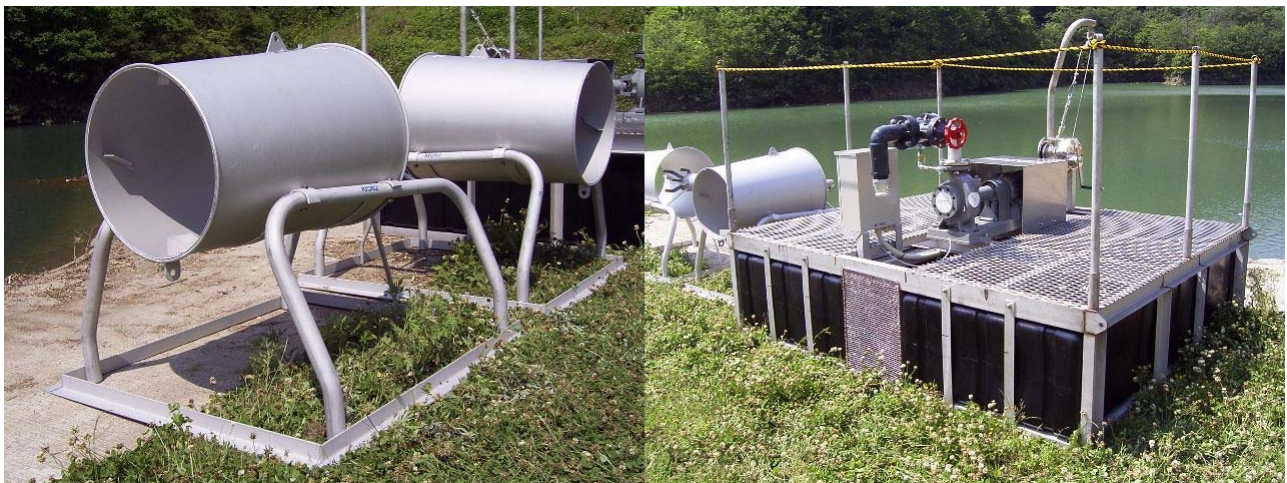
図-2 右：浮体ユニット 左：攪拌混合器
