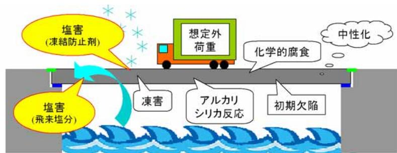
図-1 塩分飛来概要図
