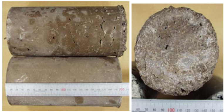
上：膨張性スラグにより膨張した供試体 膨張した供試体の上面部 下：膨張抑制剤を添加した供試体
