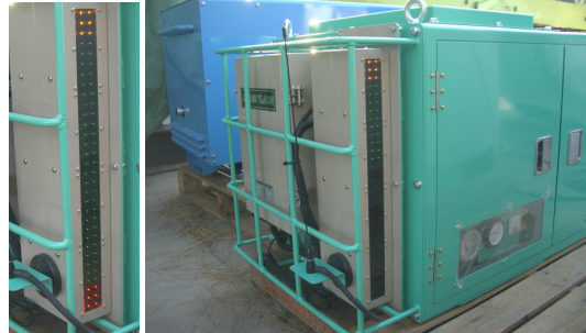
写真-7 切断翼開度計
