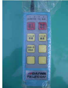
写真-6 切断翼リモコン
