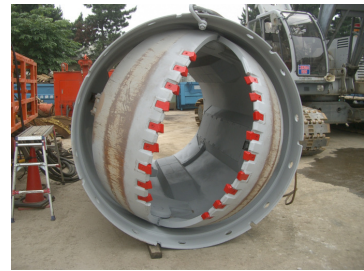
写真-2 切断翼開閉状況
