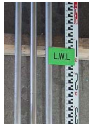
図7 19.5年間海洋に暴露した耐食性改善元素量38mass%のステンレス鋼の外観
