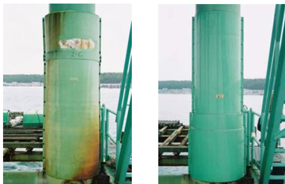
図 11 海洋暴露試験後のペトドラタム系防食材+FRP 保護カバーの外観 左は標準仕様の、右は耐衝撃仕様の FRP カバーを用いた場合
