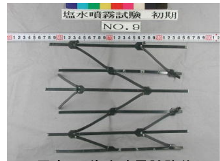
写真-2 塩水噴霧試験前
