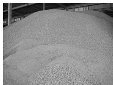
写真-3 破碎処理された廃瓦
