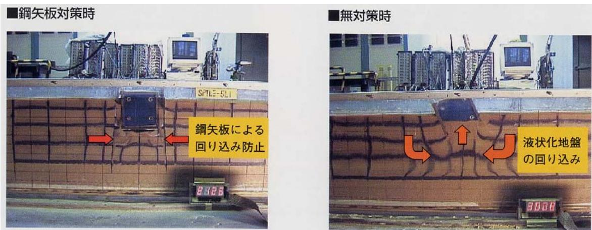
写真 - 2 鋼矢板による液状化対策効果
