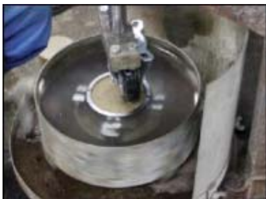
写真 - 1 簡易据え切り試験装置
