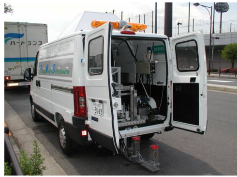
写真-3 FWD測定車の外観
