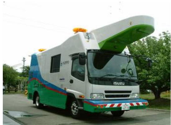
写真-1 路面性状測定車の外観
