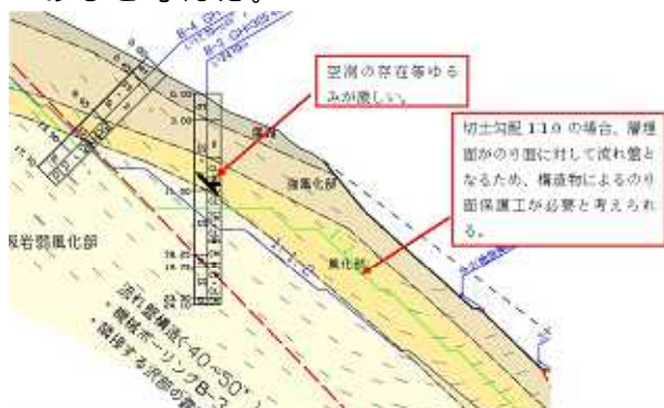
図 1 斜面上部における切土形状と層理面の関係
