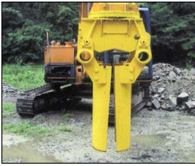
写真-1 円柱半割バケット工法
