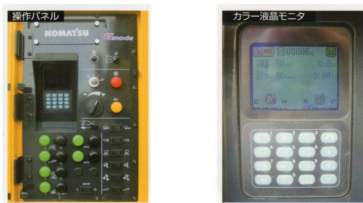
(図-3) 原料土供給量・固化材添加量・固化材比重の設定などが容易に行える。
