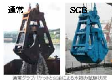
図2 . SGB による漏水状況
