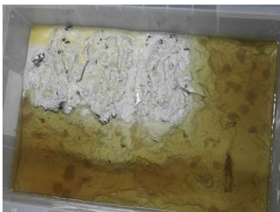
写真-5 普通コンクリートの劣化状況
