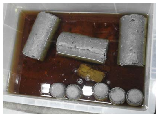
写真-6 三成分系コンクリートの劣化状況
