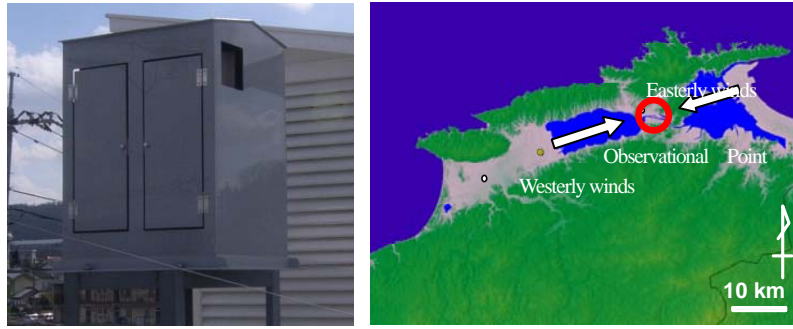
図4 東西方向の飛来塩分を採取する土研式捕集装置と松江市の位置状況
