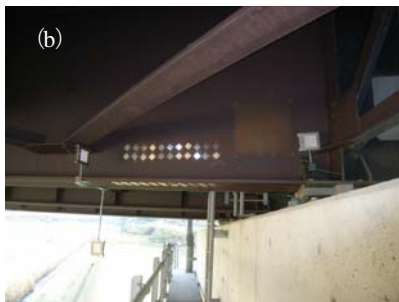
図6 山陰地域の既設橋梁の飛来塩分調査状況と飛来塩分捕集結果
