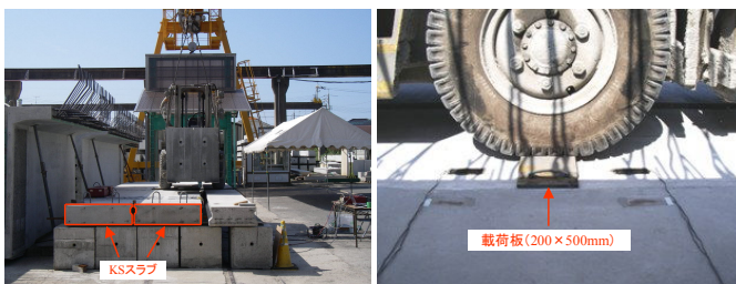
写真-3 載荷状況
