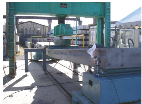
写真-1 曲げ載荷試験状況
